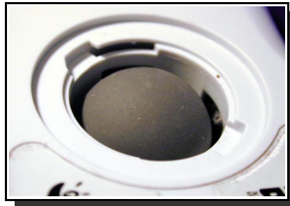
Ratón mecánico alámbrico (a la izquierda) y detalle de la bola de goma en la parte inferior con la tapa que la cubre quitada (foto central).
