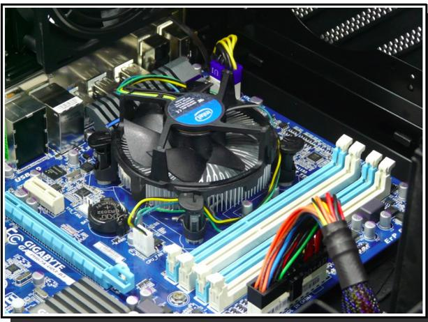
*Detalle del disipador con ventilador de un microprocesador de la marca INTEL, ya situado sobre la placa base y conectado a la corriente eléctrica.*
